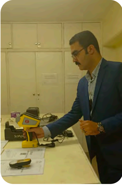
جهاز أشعة سينية XRF المتنقل لتحليل وفحص عينات التعدين والمناجم والعينات الأثرية
